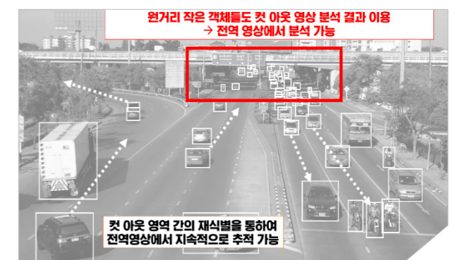
CUT-OUT 영상기반 원거리 객체검출
